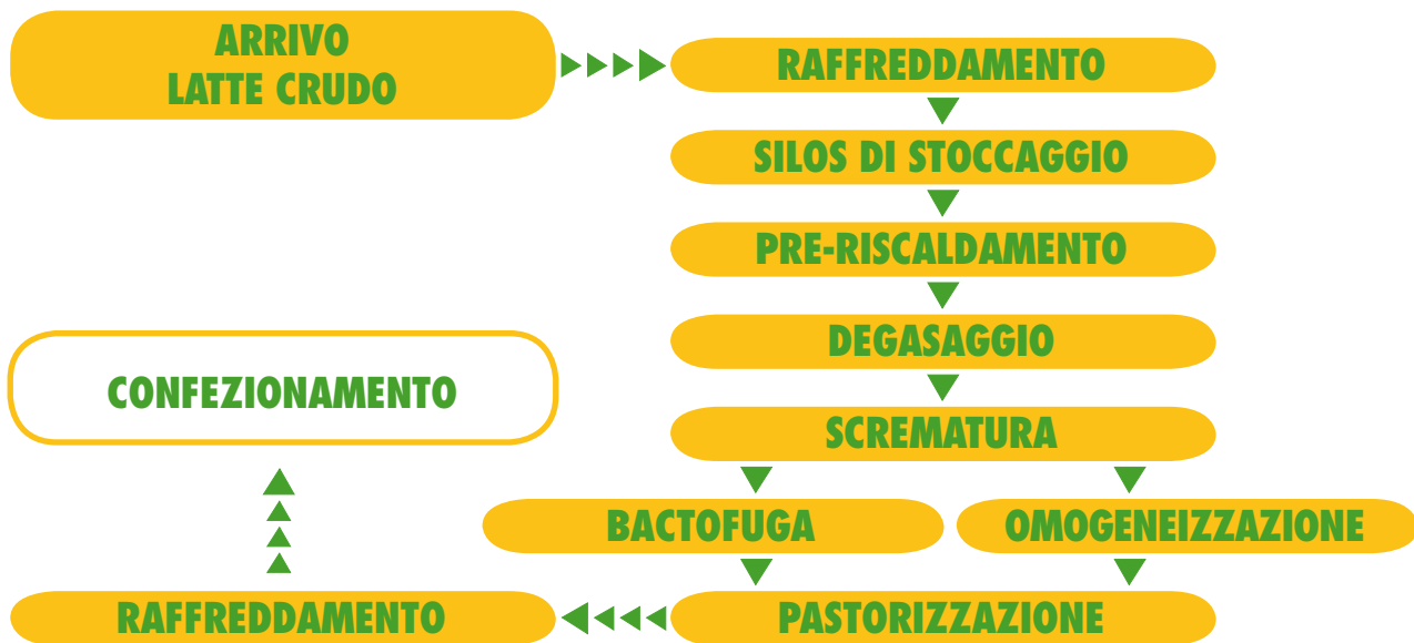
FIGURA 2 Schematizzazione del processo di pastorizzazione del latte
