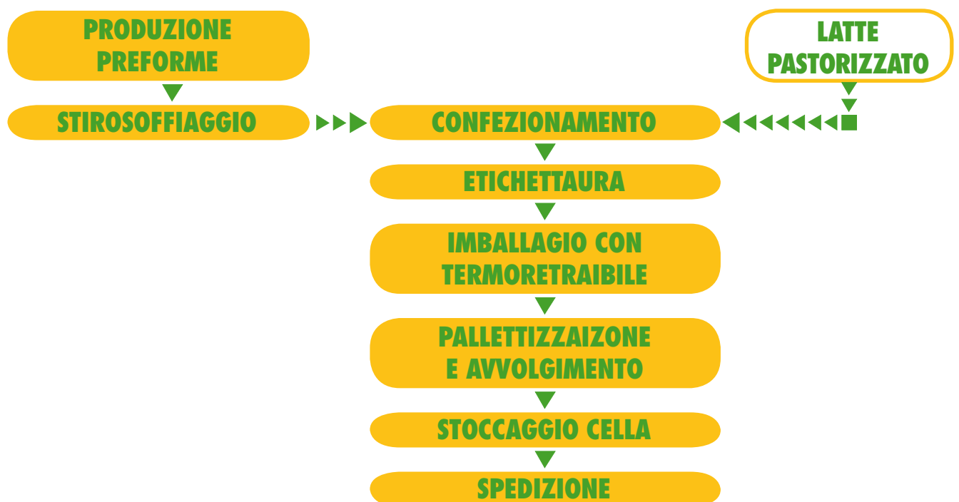
FIGURA 3 Il processo di confezionamento del latte in bottiglie in PET
